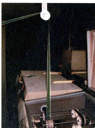
写真2: カラー現像の途中で引き出されるフィルム
